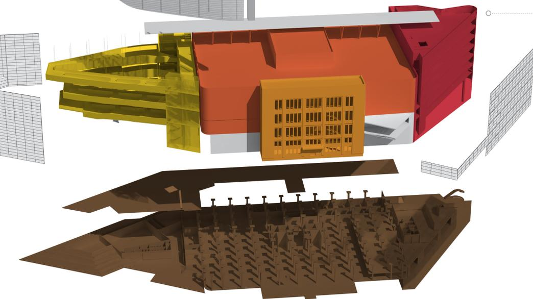
COBERTURA E VEDAÇÃO EM ESTRUTURA MISTA: CHAPAS METÁLICAS E CONCRETO CELULAR LEVE
